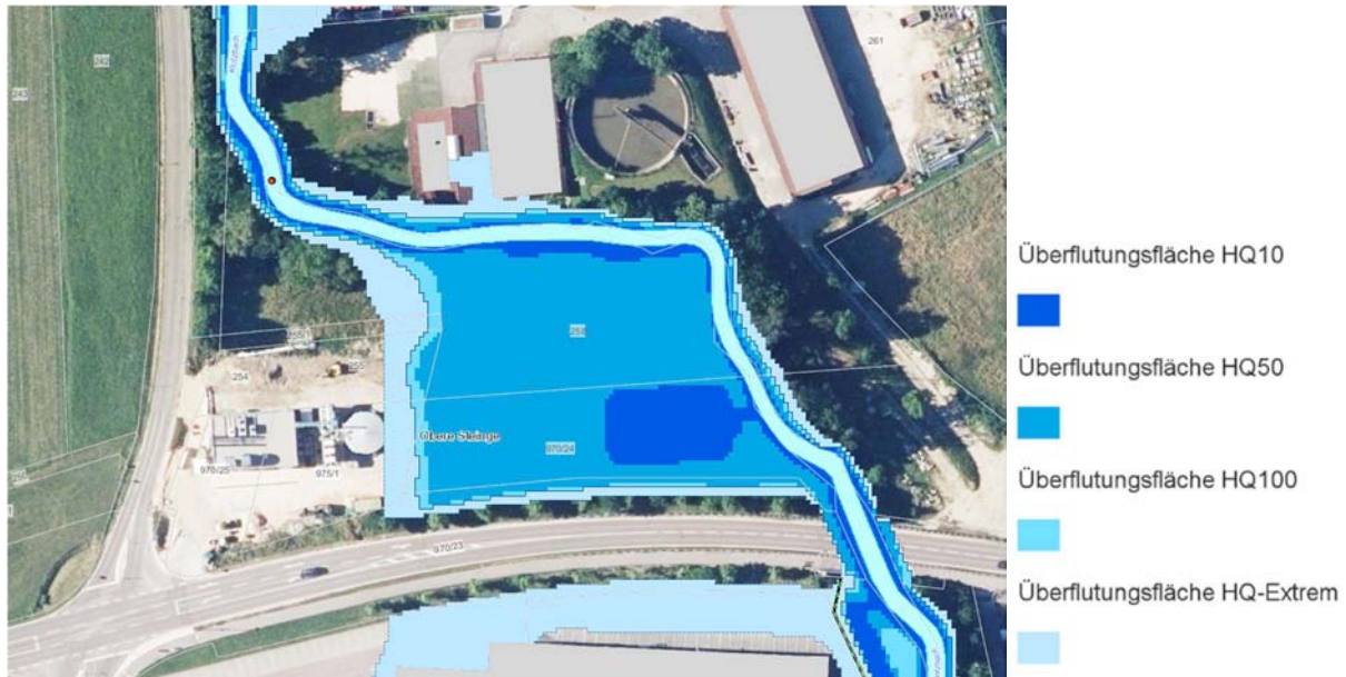
Abbildung 2: Überflutungsflächen nach Hochwassergefahrenkarte (Quelle: LUBW Kartendienst)
